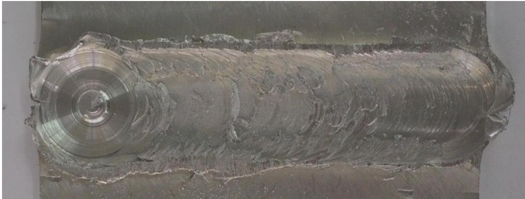
Şekil 4.65 Hibrit özellikli FDMMK levhaların SKK ile birleştirilmesi sonrası görüntüsü
