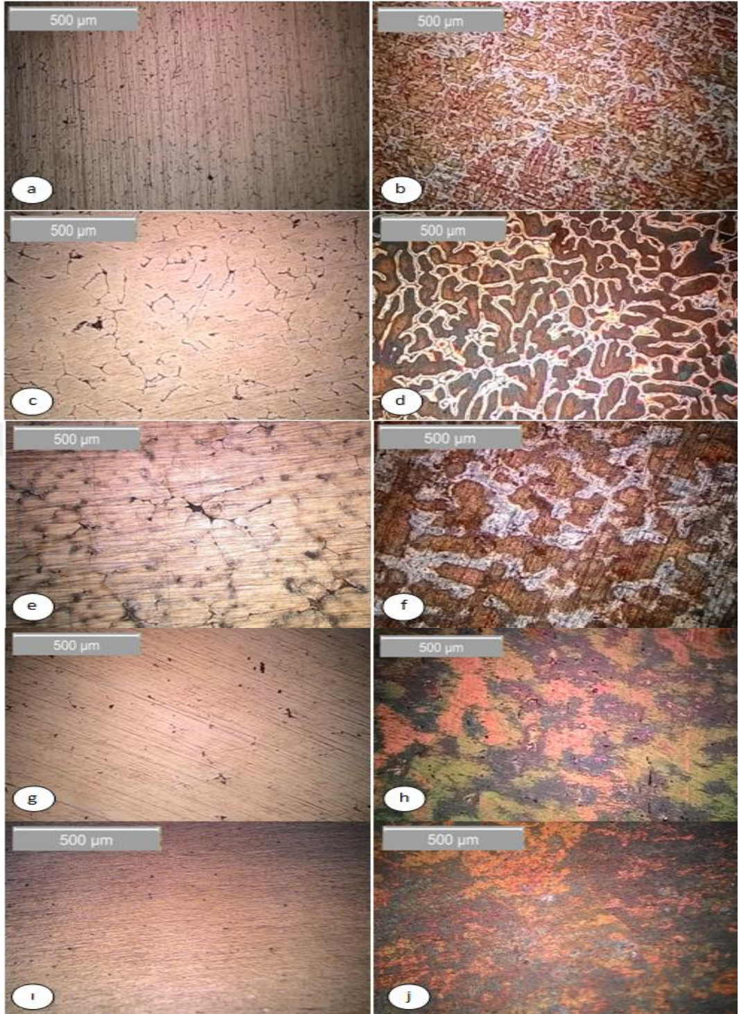
Şekil 4.1 Döküm aşaması sonrası alınan mikro yapı görüntüleri a-b) basınçsız - hızlı soğutma, c-d) basınçlı - 500 °C' de ani soğutma, e-f) basınçlı - kalıp açıldıktan sonra havada soğutma, g-h) basınçlı - kalıp içinde havada soğutma ı-j) basınçlı - fırında soğutma
