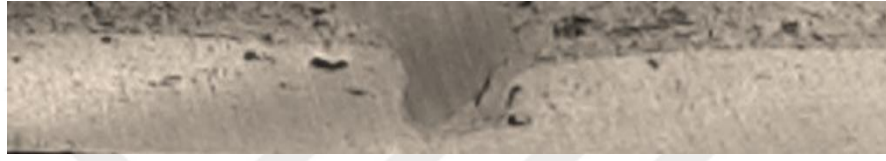
Şekil 4.66 Hibrit özellikli FDMMK numunenin SKK ile birleştirilmesi sonrası oluşan makro görüntü
