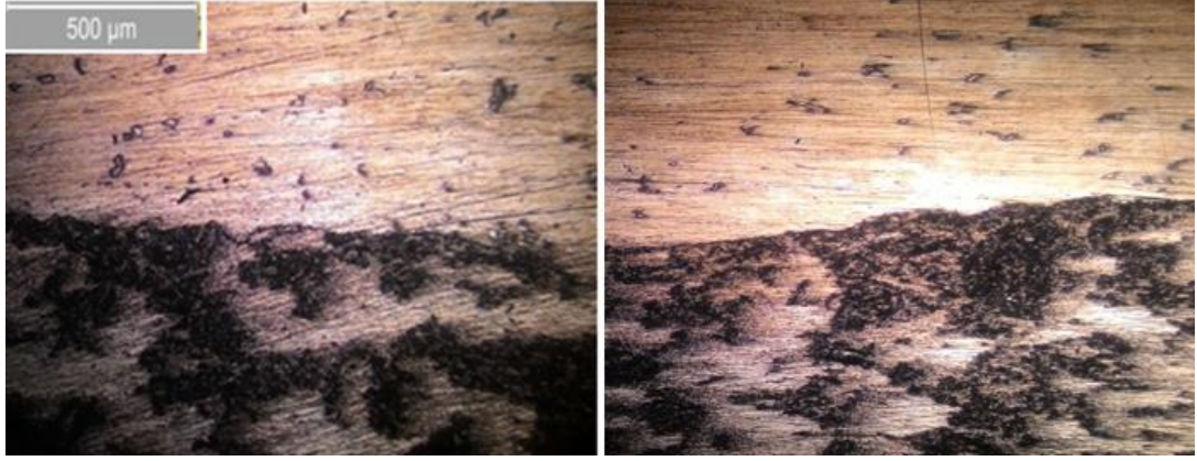
Şekil 4.42 % 15 ağırlık oranında Al_2O_3 takviye edilmiş Al 7039 Al matrisli kompozit malzeme ile takviyesiz Al 7039 malzemeden oluşan tabakalı kompozit malzemenin genel mikro yapısı
