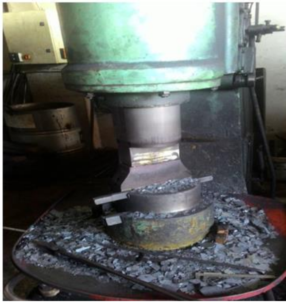
Şekil 3.7 Dövme tezgâhı ve dövülen numune görüntüsü
