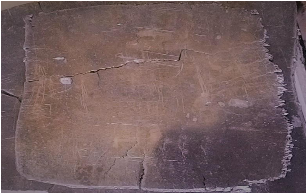
EK 2. 400 °C üzeri ısıtılarak dövülme sonucu elde edilen kompozit levhanın görünümü
