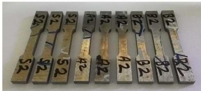
Şekil 4.30 Her bir MMK plakadan tel erezyon yöntemi ile elde edilen üç adet çekme numunesi görüntüsü
