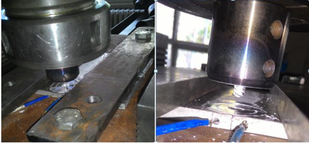
Şekil 3.22 SKK yöntemi ile birleştirme işlemi sonrası tezgâh üzerindeki görünüm
