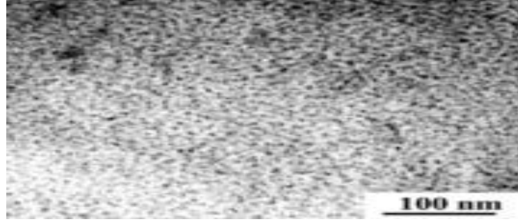
Şekil 2.6 Al-Zn-Mg-Cu alaşımına uygulanan T6 ısıt işleminin mikro yapı görüntüsü [31]
