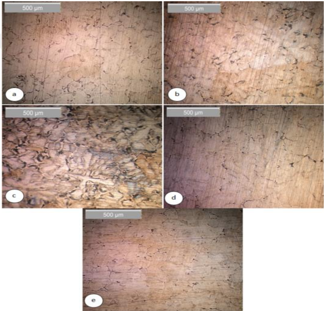
Şekil 4.3 Homojenleştirme işlemi sonrası mikro yapı görüntüleri a) 465 °C 24 saat, b) 470 °C 24 saat, c) 475 °C 24 saat, d) 480 °C 24 saat, e) 485 °C 24 saat
