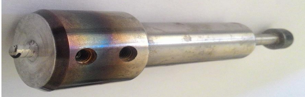
Şekil 3.20 SKK işlemi sonrasında takım ve uç görüntüsü
