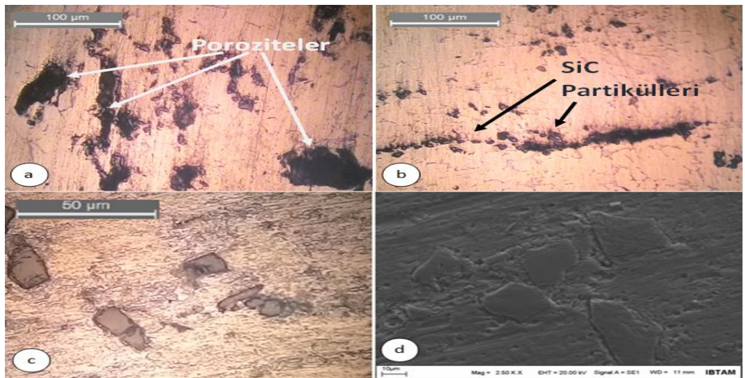
Şekil 4.20 a) Hacimce % 2 oranında takviye edilmiş SiC partiküllü MMK' nın dövme işlemi öncesinde, b-c-d) dövme işlemi sonrasında mikro yapı görüntüleri
