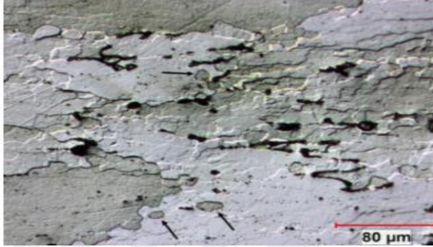
Şekil 2.4 Sıcak deformasyon sonrası 7150 Al alaşımında meydana gelen yeniden kristalleşmenin mikro yapı görüntüsü [22]
