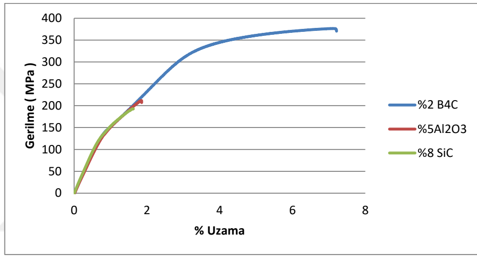
Şekil 4.38 Hacimce % 2 B 4 C, % 5 Al 2 O 3 ve % 8 SiC takviyeli MMK numunelerin çekme testi grafiği
