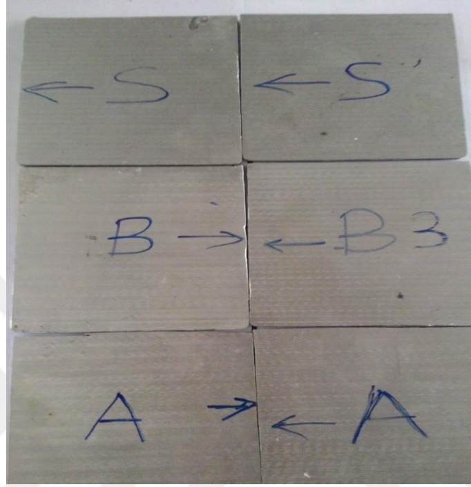
Şekil 3.15 Hibrit özellikli FDMMK üretimi için elde edilen MMK plakaların görüntüleri
