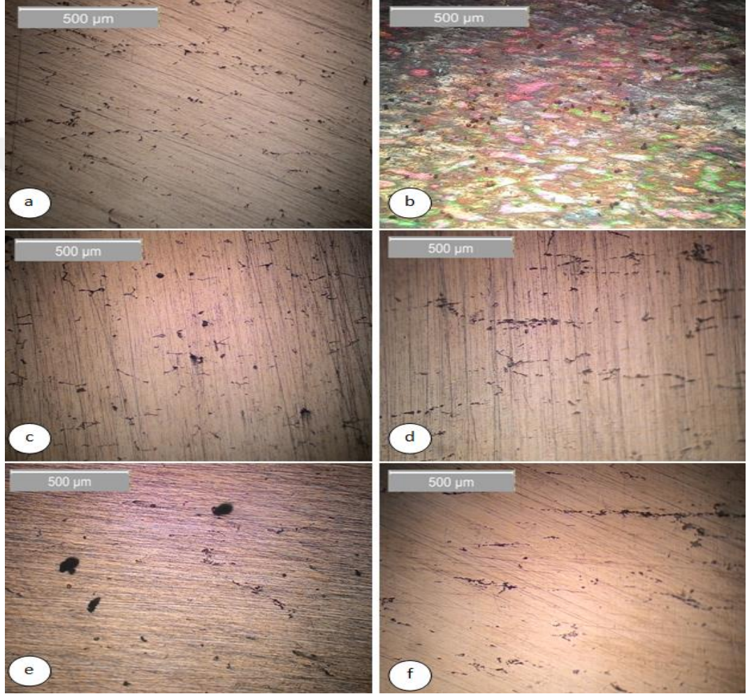
Şekil 4.7 Farklı sıcaklıklarda 2 saat bekleme süresi ile çözeltiye alma işleminin mikro yapı görüntüleri a) 400 °C, b) 420 °C, c) 440 °C, d) 460 °C, e) 480 °C, f) 500 °C
