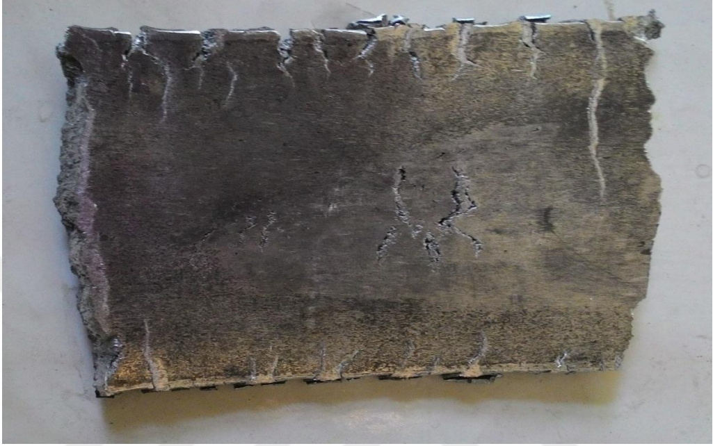
EK 1. Soğuk haddeleme sonucu elde edilen kompozit levhanın görünümü
