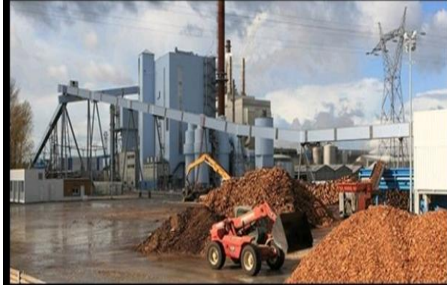
Şekil 7.18 Düzce İlindeki Biyokütle Santarlinde Kullanmak Üzere Hazırlanmış Olan Ormansal Atık Kaynaklı Biyokütleden Bir Görünüm [173]
