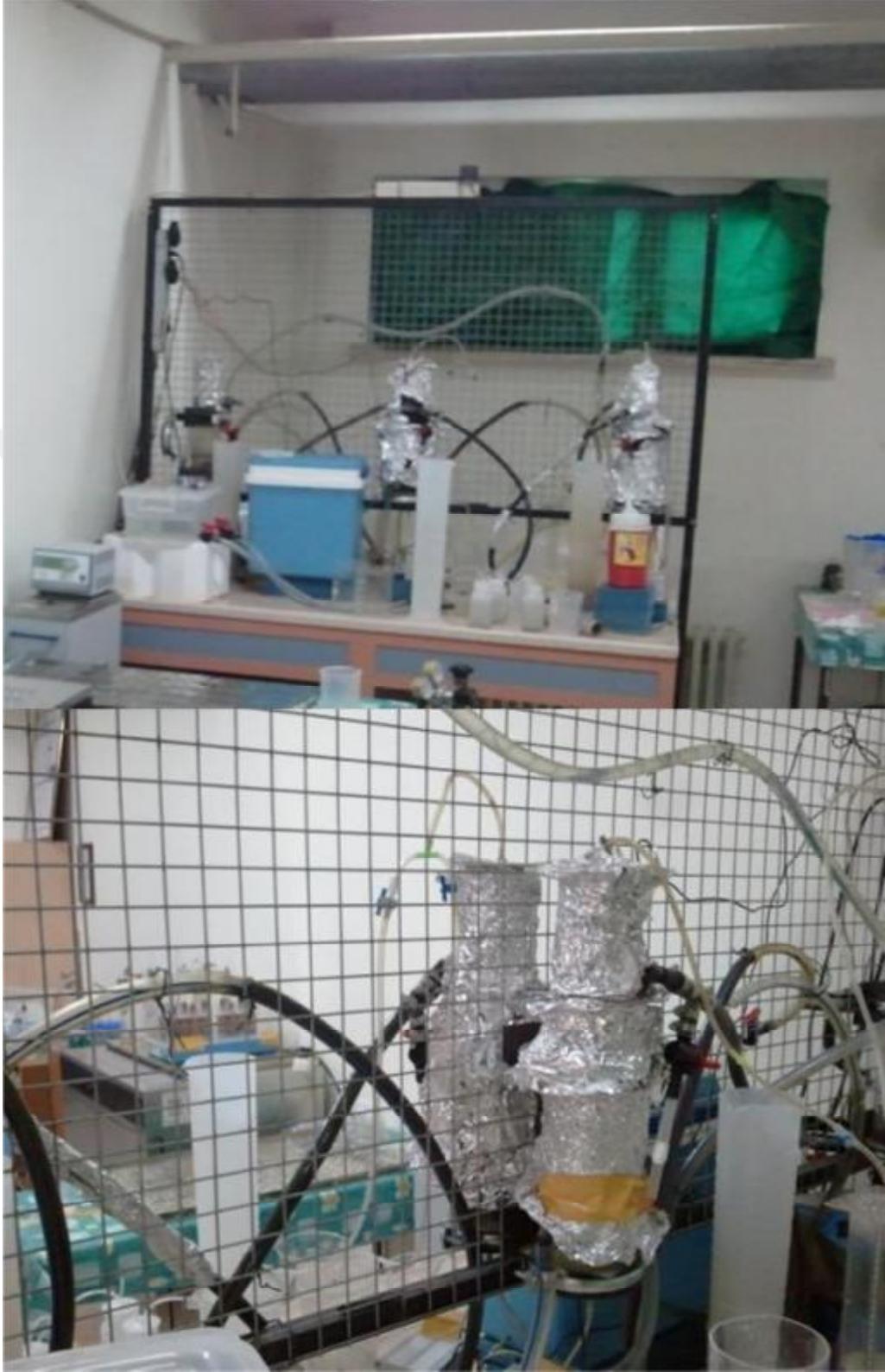
Şekil 3.3. Yukarı akışlı çamur yatağı reaktörleri fotoğrafları
