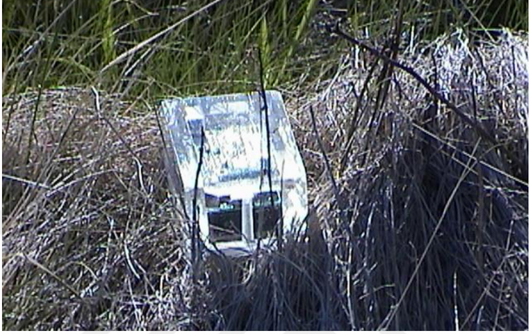
Şekil 3.4: Akrilikle korunan sensör düğüm devresi [24].
