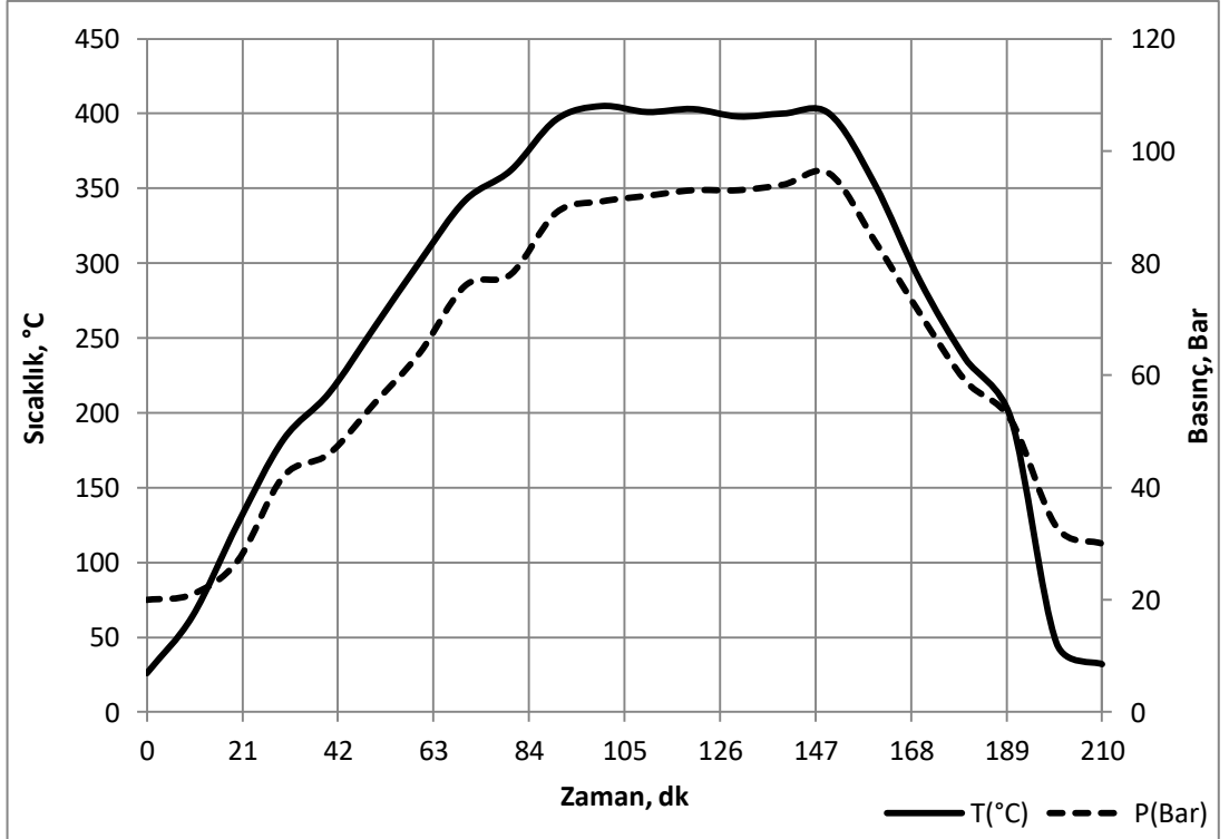
Şekil 7.12. 12'olu deneyde zamanla meydana gelen basınç ve sıcaklık değişimleri
