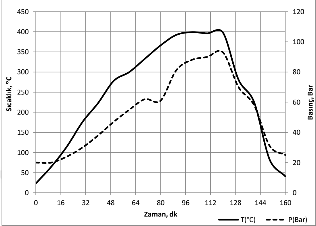
Şekil 7.7. 7'nolu deneyde zamanla meydana gelen basınç ve sıcaklık değişimleri
