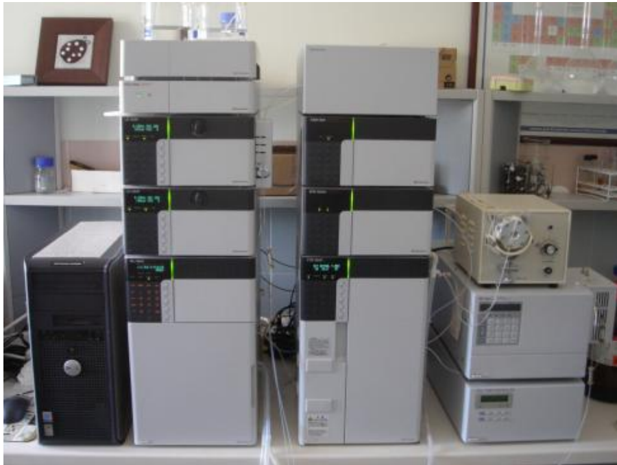
Şekil 3.3. Biyojen amin analizi için kullanılan HPLC cihazı
