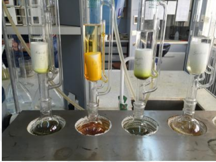
Şekil 3.1. Baharatların soksalet cihazında ekstraksiyonu
