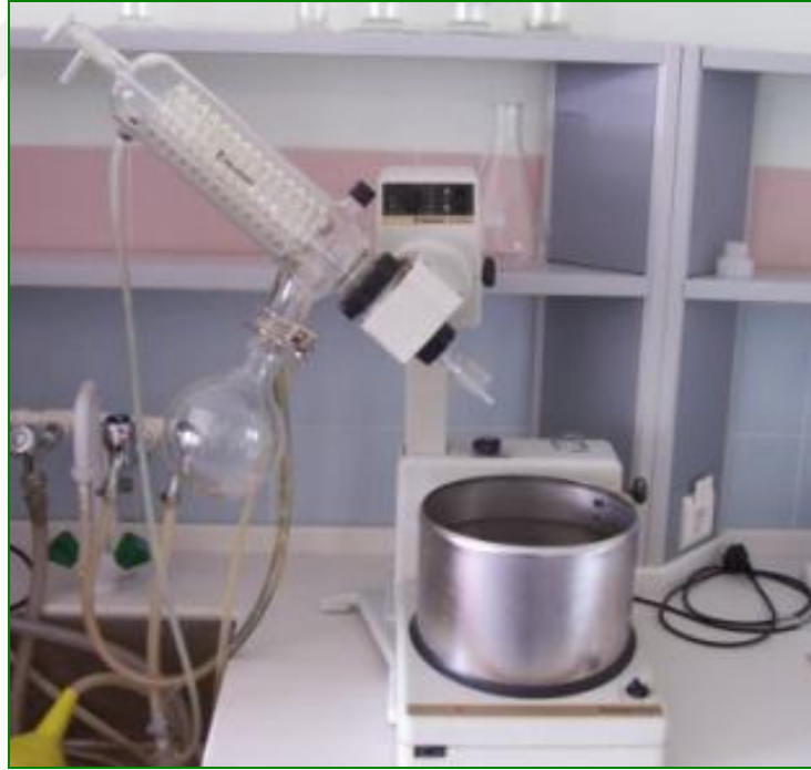
Şekil 3.2. Baharat ekstraksiyonu eldesinde kullanılan evaporatör cihazı
