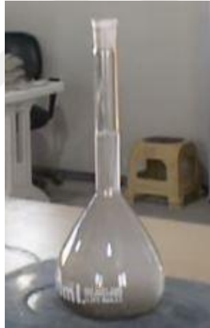
Şekil 3.8. Piknometre Tartım İşlemi
