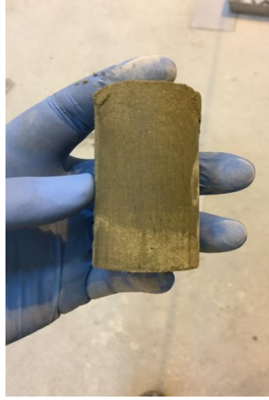
Şekil 3.19. Krikodan Çıkan Numune
