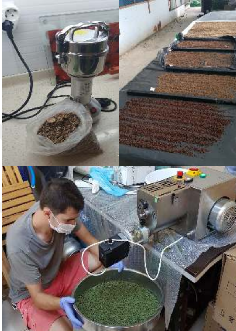
Şekil 3.10. Denemede kullanılan soğuk-kurutulmuş (freeze-dry) solucanların öğütülmesi (üst sol köşe), yemlerin peletlenmesi (alt) ve kurutulması işlemleri (üst sağ köşe).
