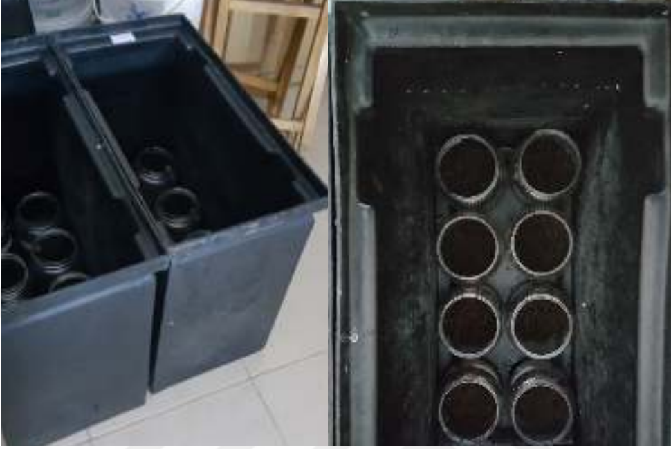
Şekil 3.4. Zenginleştirme denemelerinin yürütüldüğü ortam ve koşullar (kops kutuları içine yerleştirilen plastik kültür kapları)
