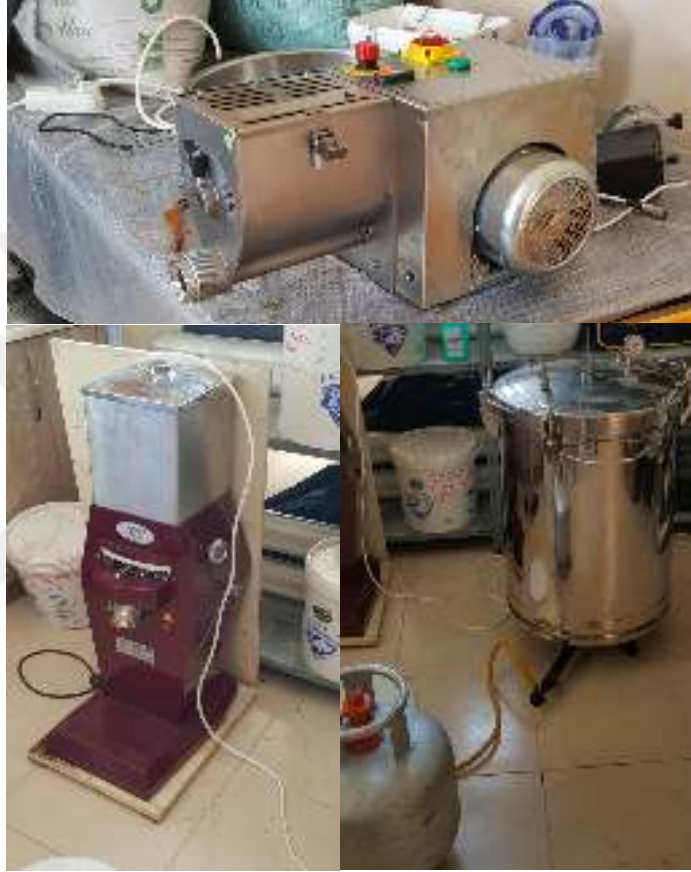
Şekil 3.9. Deneme yemlerinin preslendiği pellet makinası (üste), hammaddelerin öğütüldüğü makina (solda) ve peletlerin pişirildiği düzenek (sağda)
