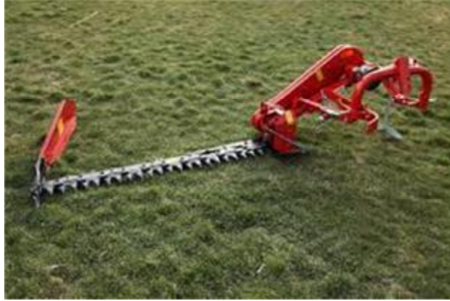
Şekil 3.6. Denemede kullanılan çift bıçaklı çayır biçme makinası
