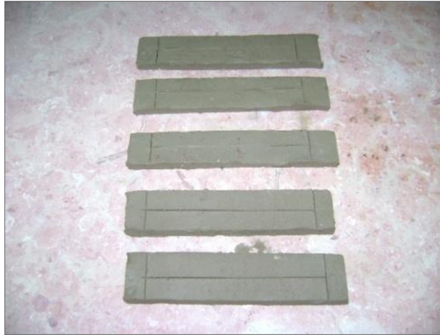
Şekil 35. Seyhan Baraj Bölgesi kili ile hazırlanan çekme çubukları
