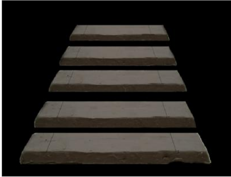
Şekil 36. Şamotlu çamur ile hazırlanan çekme çubukları
