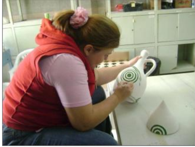
Şekil 63. Amfora üzerine dekor uygulanışı
