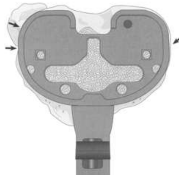
Şekil 41. Tibial komponentin boyutlandırılması
