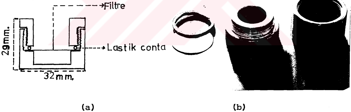
Şekil 3: Milipor filtre yönteminde kullanılan kameranın; a) Boyuna kesiti b) Çekilmiş fotoğrafı.
