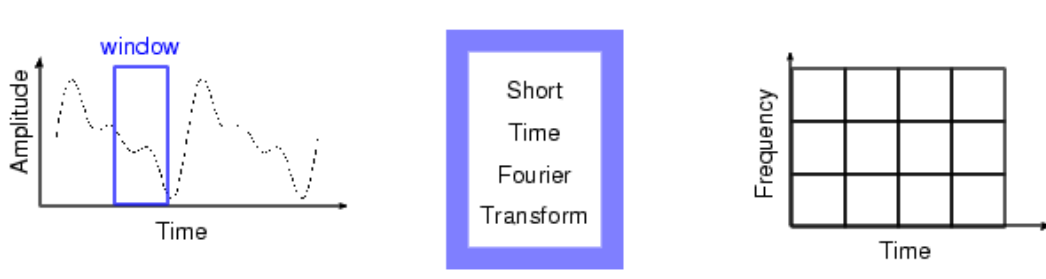
Şekil 4.2 : Kısa süreli fourier dönüşümüne uğrayan bir sinyalin zaman-frekans ekseninde gösterimi.
