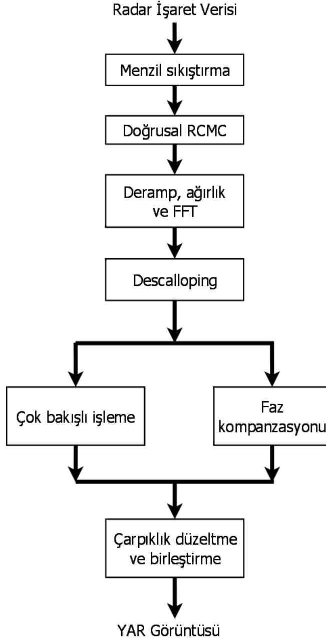
Şekil 2.10 : SPECAN YAR görüntü işleme algoritması.
