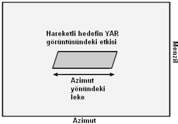
Şekil 3.2 : Sadece azimut yönünde hareket eden hedefin YAR görüntüsündeki etkisi.
