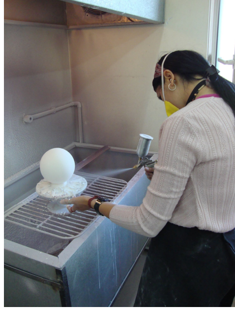
Şekil- 3.1.2.8. Sırlama Aşaması (Püskürtme)
