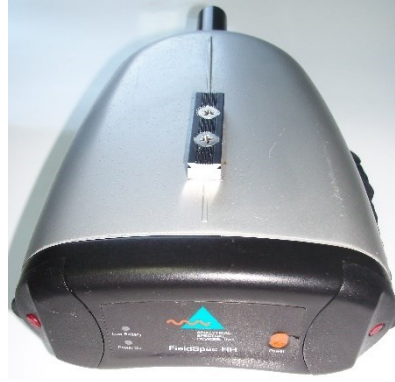
Şekil 2.12 : ASD arazi el spektrometresi.
