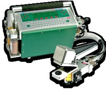
Şekil 2.11 : LI-6400XT Fotosentez ve Işınım Çözümleyici (LICOR, 2013).
