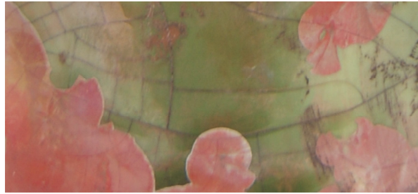
Şekil- 3.3.34 Redüksiyon sonrası kristal sır detayı
