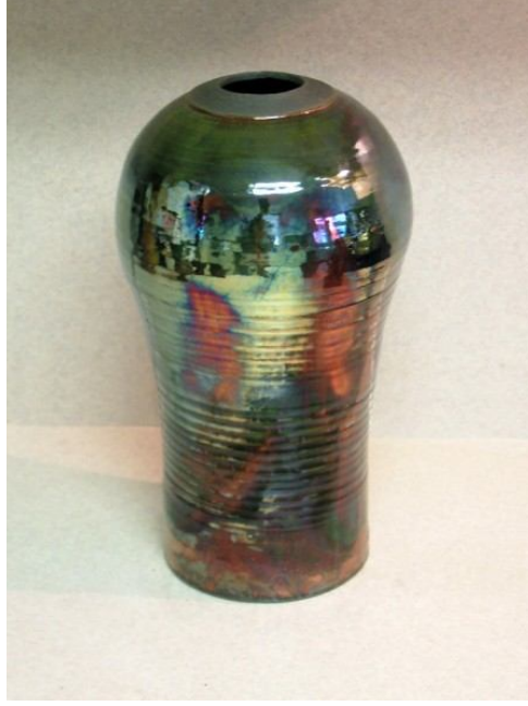
Şekil- 2.1.1 Redüksiyon ortamı tam sağlanamamış bakır oksitli vazo
