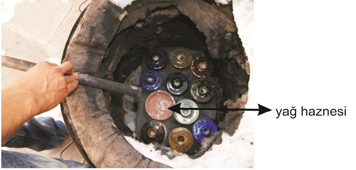
Şekil- 3.3.2 Fırın İçerisindeki Yağ Haznesi
