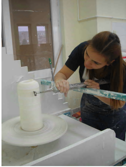
Resim 55. 1 Alçı Torna Biçimlendirme Aşaması
