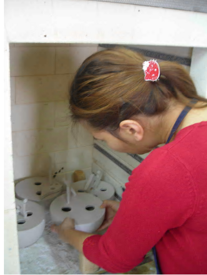
Resim 58 Bisküvi Fırınına Yerleştirme Aşaması
