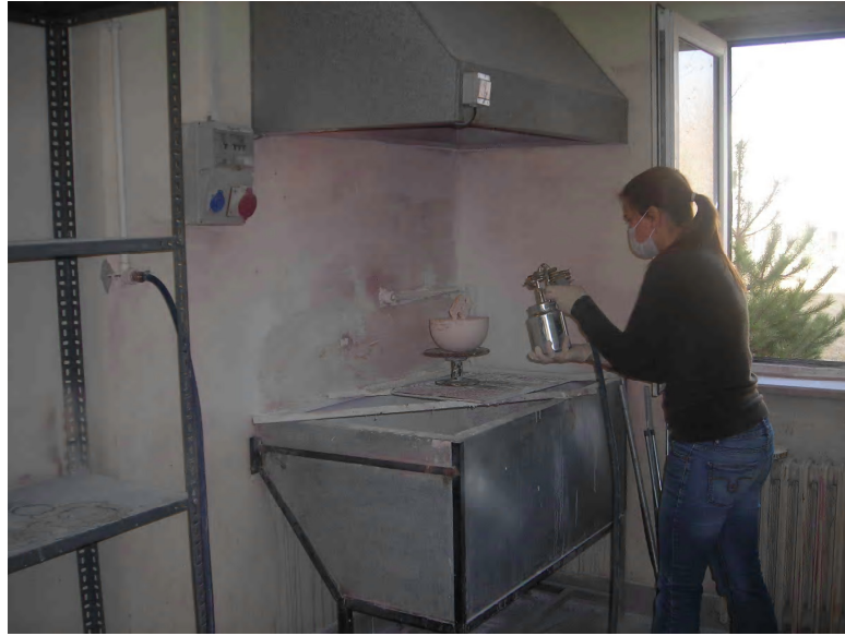
Resim 59. 2 Çalışmaların Pistole Yöntemi İle Sırlama Aşaması
