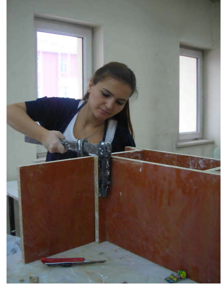
Resim 55. 2 Alçı Kalıp Alma Aşaması
