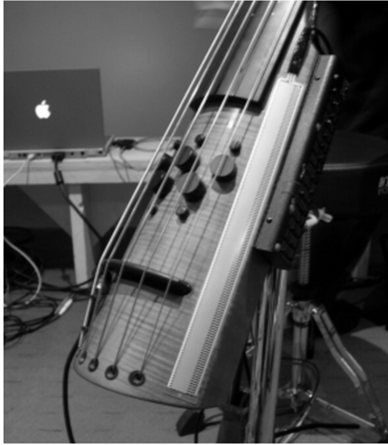
Şekil 42. Kontrbasa yerleştirilmiş elektronik sensörler (Reck and Wanderley, 2006, 23).
