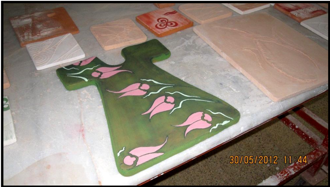
Resim 131. Sır Altı Kırmızı Çini Astarı Krom Oksit, Demir Oksit Ve Şeffaf Sır Uygulaması
