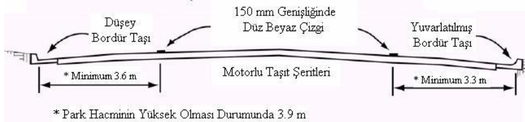
Şekil 2.7 : Motorlu taşıtların park etmesine izin verildiği fakat park bölgesinin işaretlenmediği platform (Uz, 2003).
