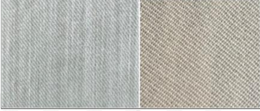
Şekil 3.4. Dokuma ve örme kumaş (D1 ve Ö1) örneklerinin lup altında görüntüleri
