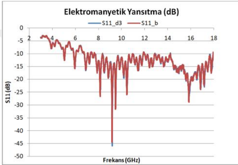
Şekil 4.27. Elektromanyetik yansıtma açısından 3 no.lu dokuma kumaş örneğinin boşluk ile karşılaştırılması
