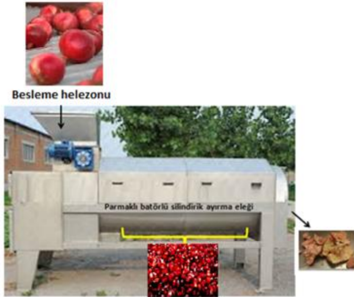
Şekil 1.3. Nar taneleme makinası
