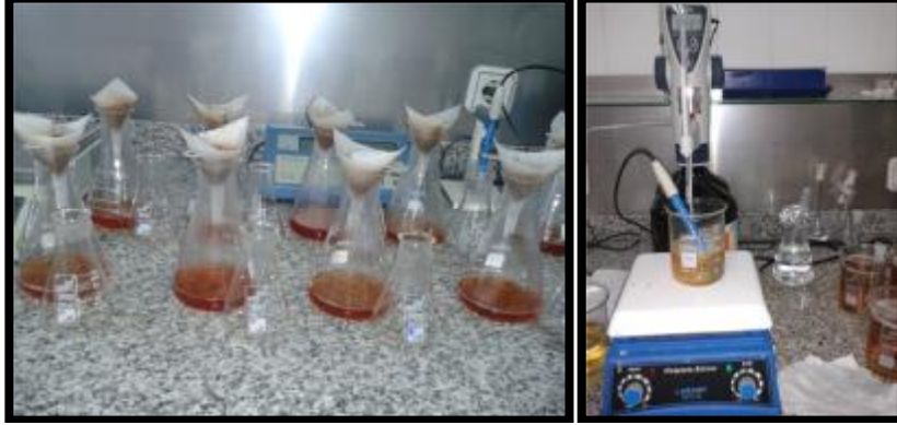
Şekil 3.16. Anthron Yöntemine Göre Toplam Nişasta Tayini (Orijinal, 2012).
