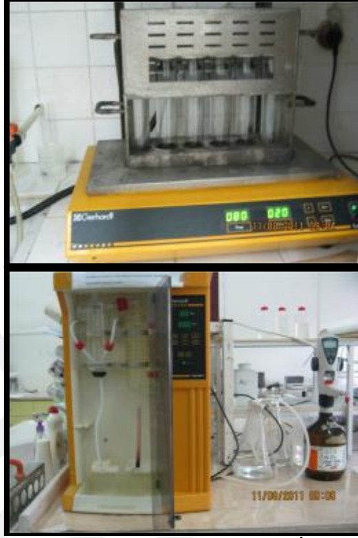
Şekil 3.14. Çilek Çeşitlerinin Yapraklarında Azot İçeriğinin Belirlenmesinde Kullanılan Kjeldahl cihazı(Orjinal, 2011)
