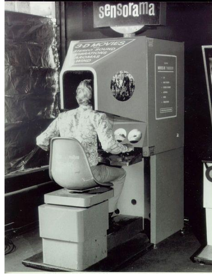
Resim 68: Morton L. Heiling'in tasarlamış olduğu "Sensorama" sanal gerçeklik makinesi
