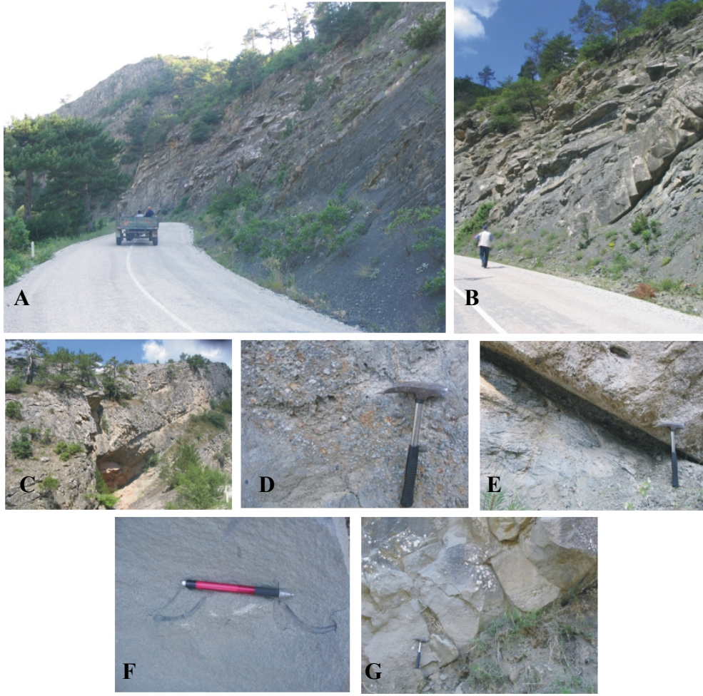
Şekil 19. Kayaboğazi mevkiinde, Taraklı formasyonunun litolojilerini gösterir fotoğraflar. A- Kayaboğazi kesitinde ince tabakalı ve ince taneli (yüksek oranda şeyl) seviyelerden; kaba taneli ve masif Taraklı formasyonuna geçiş, (genleşme yönü sol-üst yani G yönündedir), B- Taraklı fm. tabakalarının en alt kesimleri, C- Kesit tavanındaki masif tabakalar, D- Kesit orta kesiminde, kumtaşı tabakası içinde mercekşel çakıl seviyesi, E- Kesit orta kesiminde kaba taneli kumtaşları arasında sıkışmış ince şeyl tabakası, F- Kazma yapıları, G- Kesit alt kesiminde, kumtaşı tabakası içinde mercekşel çakıl seviyesi.
