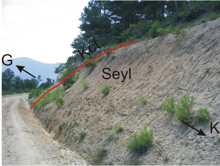
Şekil 41. 1203 numaralı lokasyonda Paleosen kiretaşı ve Paleosen yaşı şeyl dokanaėı, masif ve tabakasız kiretaşı, pek de iyi ve belirgin tabakalı olmayan altare şeyl tabakaları üzerinde irice bloklar halinde durmaktadır.
