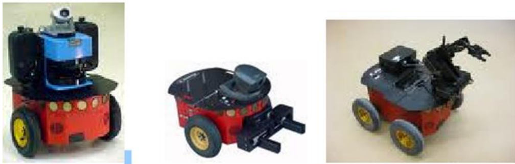
Şekil 4.2 : Tutucuları ile öne çıkan mobil robotlar
