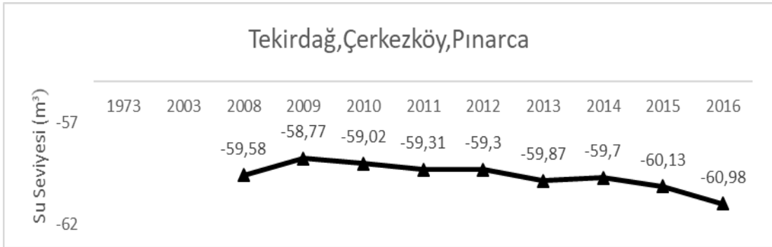
Çizelge A.2 : Tekirdağ, Çerkezköy, Pınarca yer altı suyu azalım grafiği (Tekirdağ İli Çevre ve Şehircilik İl Müdürlüğü, 2016).
