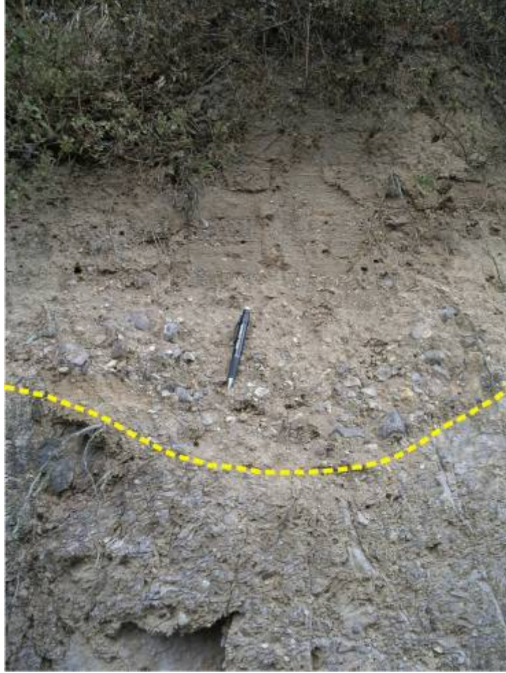
Şekil 2.27.: Başbüyük Keçi Yatağı Mevkii'nde, üstte görülen Belgrad Formasyonu ile alttaki Kurtköy Formasyonu'nun sınırı görülmektedir. Bakış D'ya.
