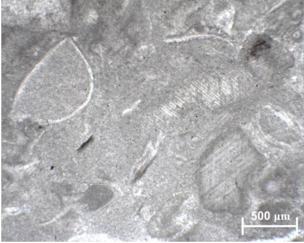
Şekil 2.14.: Dolayoba Formasyonu'na ait Krinoid sapları ve brakiyapod kavkı parçaları (Doğal ışık)
