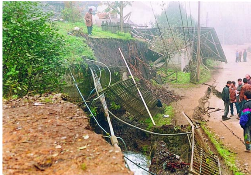
řekil 6.34. Hamamyanı Ky'nde 1999 Dzce Depremi sırasında geliřmiř en byk eęim atım (3.7m) (Tamer Duman'ın izni ile)
