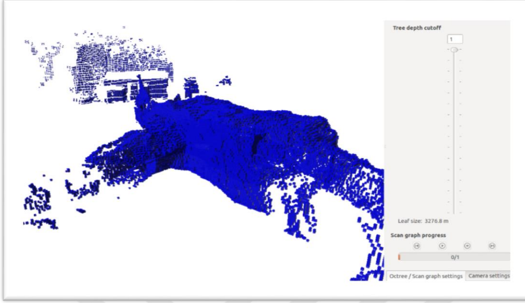
Şekil 3.3 Octomap kullanarak 3B nokta bulutunun görselleştirilmesi
