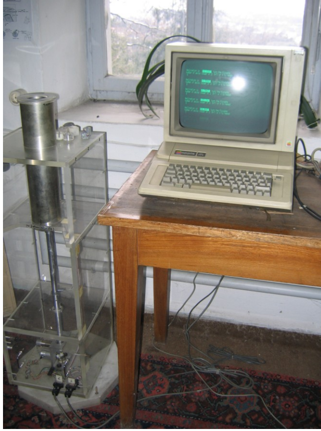
Şekil 4.5. Fransız CFR kuruluşu imalatı olan düşük hızlı Spinner Manyetometresi.
