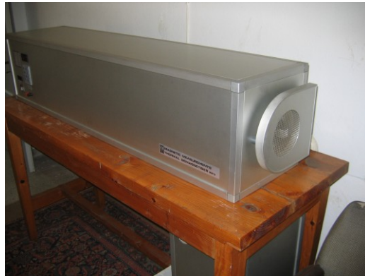
Şekil 4.4. Isıl Temizleme işlemlerinin gerçekleştirildiği MMTD-60 model ısıl temizleme fırını.
