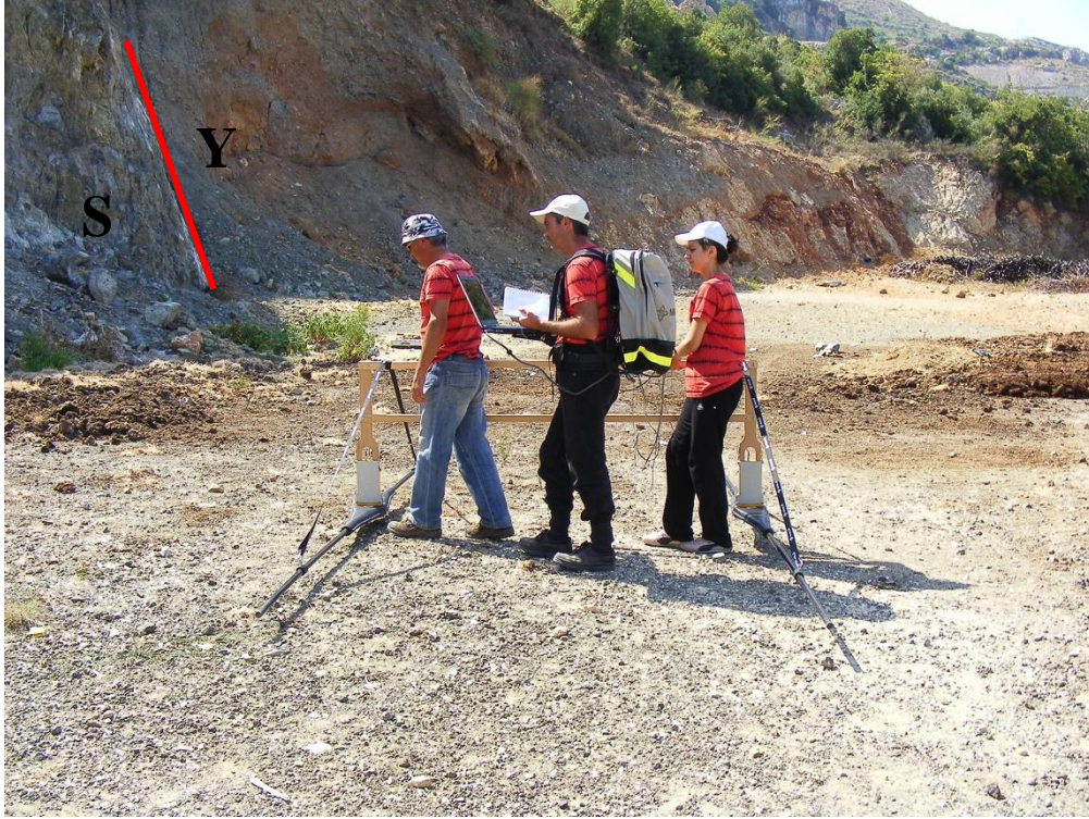
Şekil 3.9 : Serpantin (S) ve yamaç molozunu (Y) dokanağa getiren Gözene fayının alüvyona daldığı yerdeki 25 MHz'lik anten kullanılarak yapılan GPR ölçümü (kırmızı çizgi fay aynasını göstermektedir).
