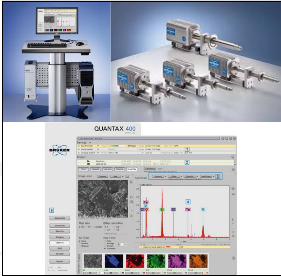
Resim 3.6. Bruker Quantax 400 The Flash® 5000 series EDS (Berlin/Germany)
