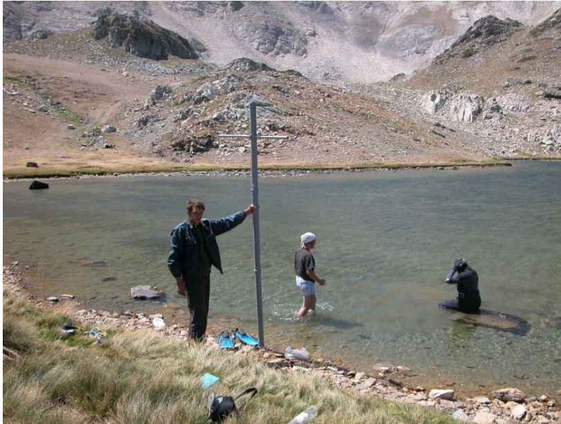
Şekil 2.2 : Uludağ Zirvesi Kara Göl'den el karotiyeri ile çökel alınması.
