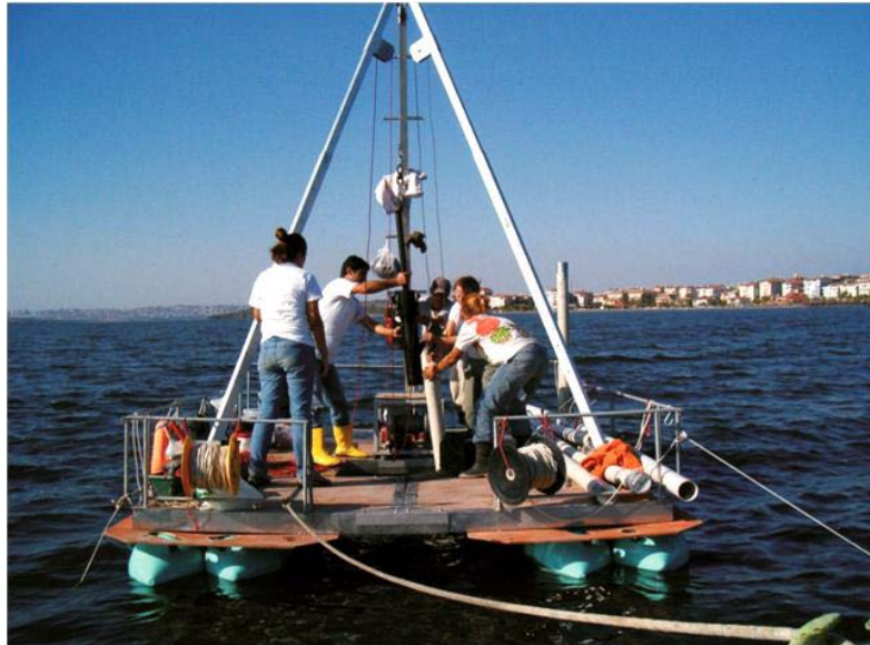
Şekil 2.1 : Küçükçekmece Lagünü, portatif platform üzerinde çakma piston karotiyesi ile çökel alımı.
