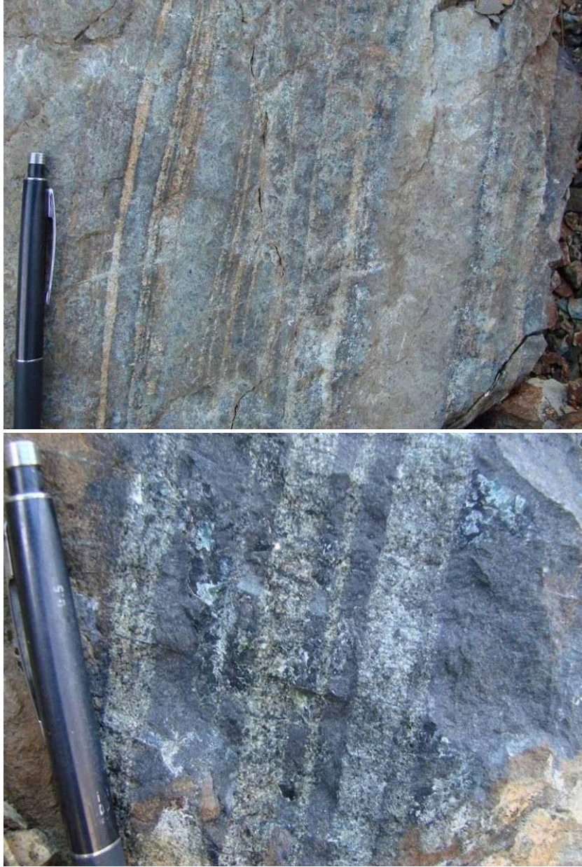
Şekil 5.4 : 3-20 mm kalınlığındaki metapiroksenit-metaperidotit bantlaşması; metaperidotitler koyu renkli ve görece daha kalın, metapiroksenitler ise bej-yeşilimsi ince bantlar halindedir (lokasyon 2053; Koordinat-UTM: 36T/ 02 71 807 N - 45 01 867 E).
