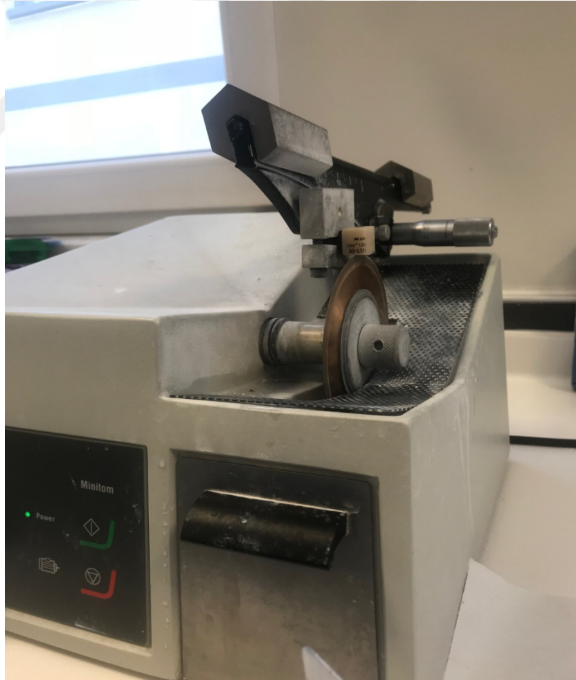
Resim 3. İndirekt restorasyon materyallerinden kesit elde edilmesi
