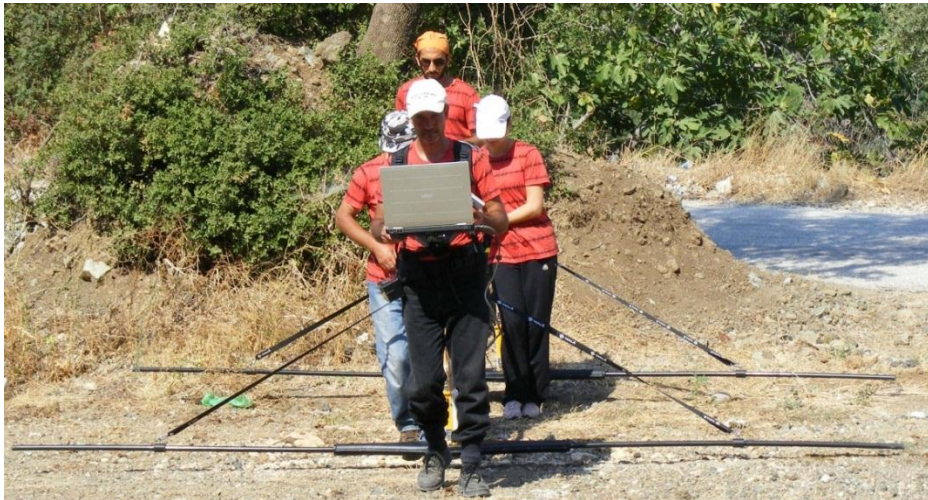
Şekil 6.1: 25 Mhz'lik antene sahip Mala marka Ramac model Yer radarı ölçüm cihazı
