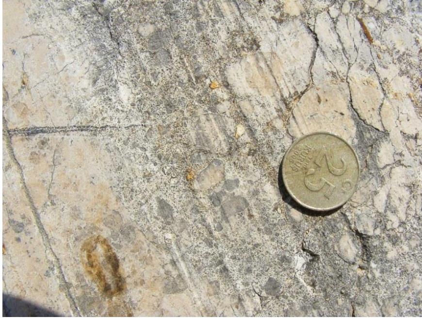
Şekil 4.13: Şekil 4.12 lokasyonuna ait, Antakya fayının fay yüzeyinde oluşturduğu fay çizikleri ve çentikleri
