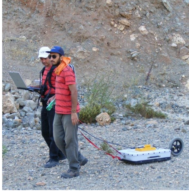
Şekil 6.2: 250 Mhz'lik antene sahip Mala marka Ramac model Yer radarı ölçüm cihazı
