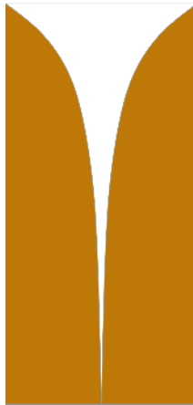
Şekil 4.4: Ekponansiyel Konik Oluk Anten. [4]
