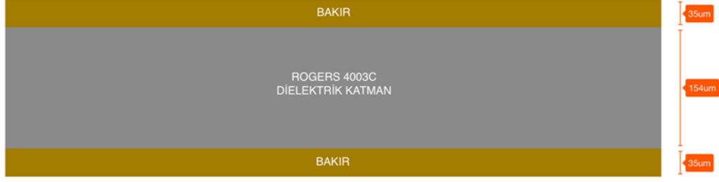
Şekil 6.4: Üretime giden levhanın kalınlıklarını ve katmanları.
