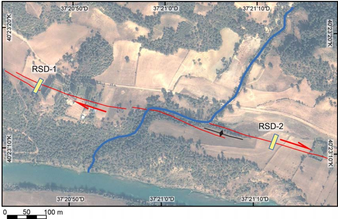
Şekil 5.9 : Aralarında yaklaşık 600 m mesafe bulunan Reşadiye-1 (RSD-1) ve Reşadiye-2 (RSD-2) hendeklerinin birbirlerine göre konumlarının IKONOS uydu görüntüsü üzerinde iz düşümü. İki hendek sahası da belirgin fay morfolojisine sahipken, aralarında yer alan ve 150 m birikimli atıma sahip bir dere fayın bu uzun süreli etkinliğinin göstergesidir. RSD-1 birbirlerine paralel iki adet fay kolunun yarattığı çizgisel bir çöküntü alanı üzerinde, RSD-2 ise faylanma sonucu ötelenmiş bir tarla sınırının yanında açılmışlardır. RSD-2'nin hemen batısında yer alan bir basınç sırtı fayın yersel sıkışmalı bir sıçrama yapmasına bağlı olarak gelişmiştir.
