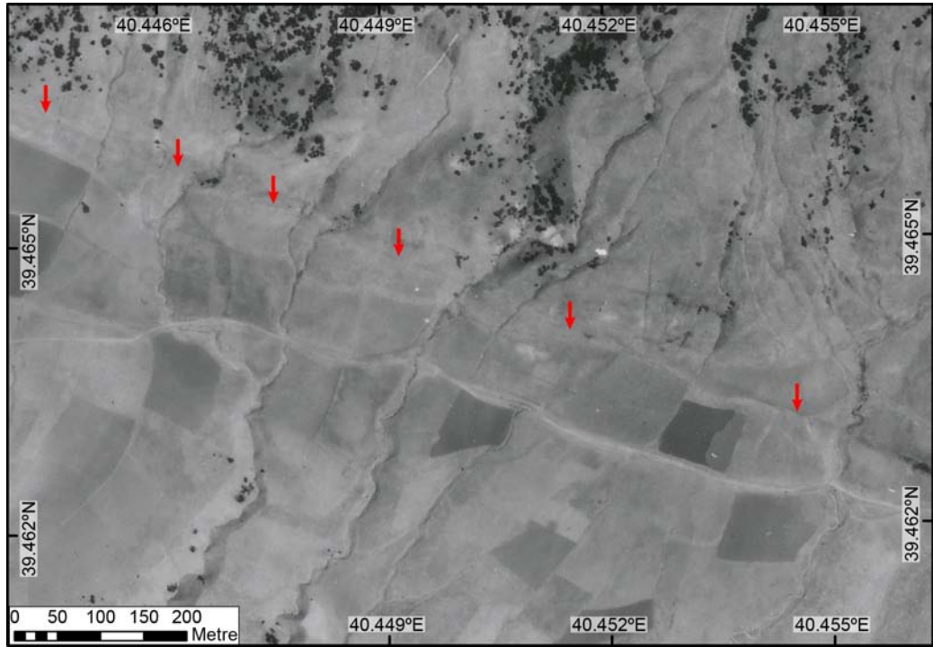
Şekil 4.29 : Yedisu Havzası'nın kuzey kenarında Ayanoğlu ve Eskibalta köyleri arasında kalan kesimde, fay belirgin bir çizgiselliğe sahiptir. Bu hat boyunca farklı yaşlardaki dereler 8 ila 25 m arasında değişen miktarlarda ötelenmiştir. Kırmızı oklar, fayın izini gösterir.
