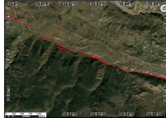
Şekil 4.34 : (a) Günalan doğusunda uzamış sırt ve güneyinde uzanan fay, (b) Kuzuluk kuzeyindeki bel verme gölcüğü, (c) Damlaca Köyü'nde ötelenmiş dere ve (d) Çatalçam güneyinde dağ önünde yer alan belirgin çizgisel sırt
