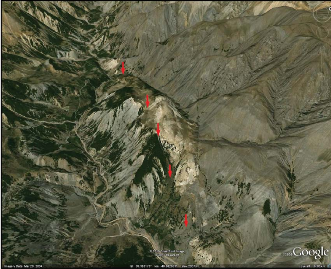
Şekil 4.12 : Elmalı köyünün kuzeyinde yer alan sırtın fay tarafından birbirinden ayrılmış iki farklı birimden oluştuğu SPOT görüntü üzerinde açıkça görülür. Kırmızı oklarla gösterilen fay, sırt ekseninde eğer yapısı oluşmasına yol açmıştır.
