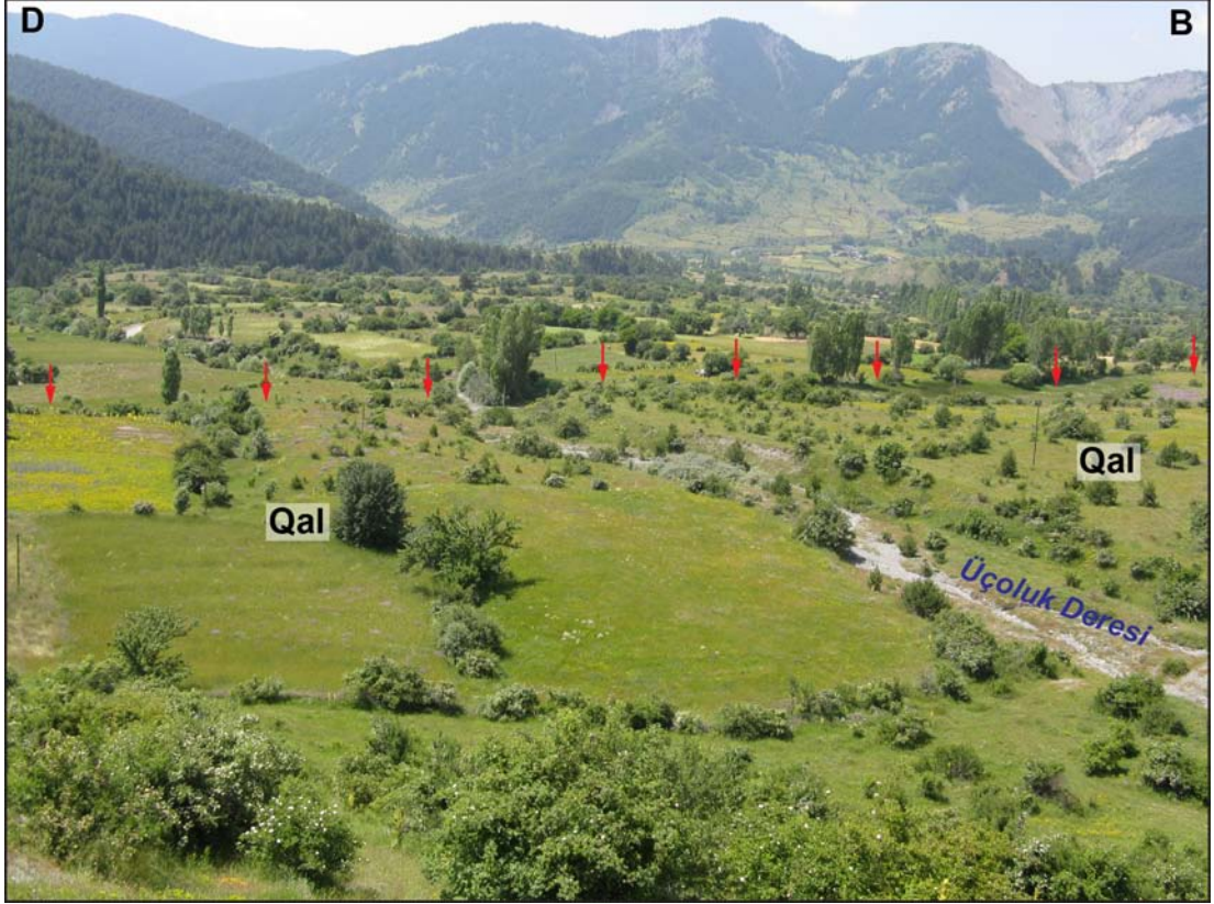
Şekil 4.52 : Üçoluk deresinin oblik fotoğrafı. Bu çalışma alanının ana morfolojik yapısı geniş bir yayılıma sahip alüvyal yelpaze (Qal) yüzeyidir. Ilgaz Segmenti'nin gidişatı kırmızı oklarla gösterilmiştir.
