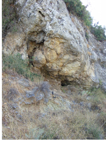
Şekil 4.2 : Sümerler Mahallesi Mevkii'nde Kızıldağ ofiyoliti ile Sebenoba formasyonu arasında sınır oluşturan Antakya fayı.
