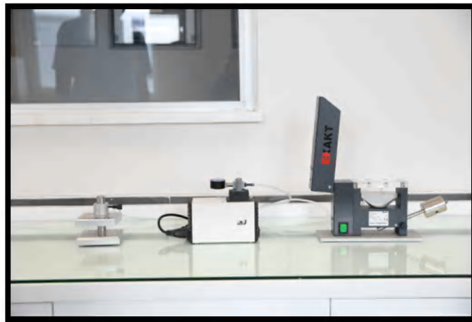
Resim 17. Örnekleri Lama Yapıştırma Ünitesi (Exakt Apparabau, Norderstad, Almanya)
