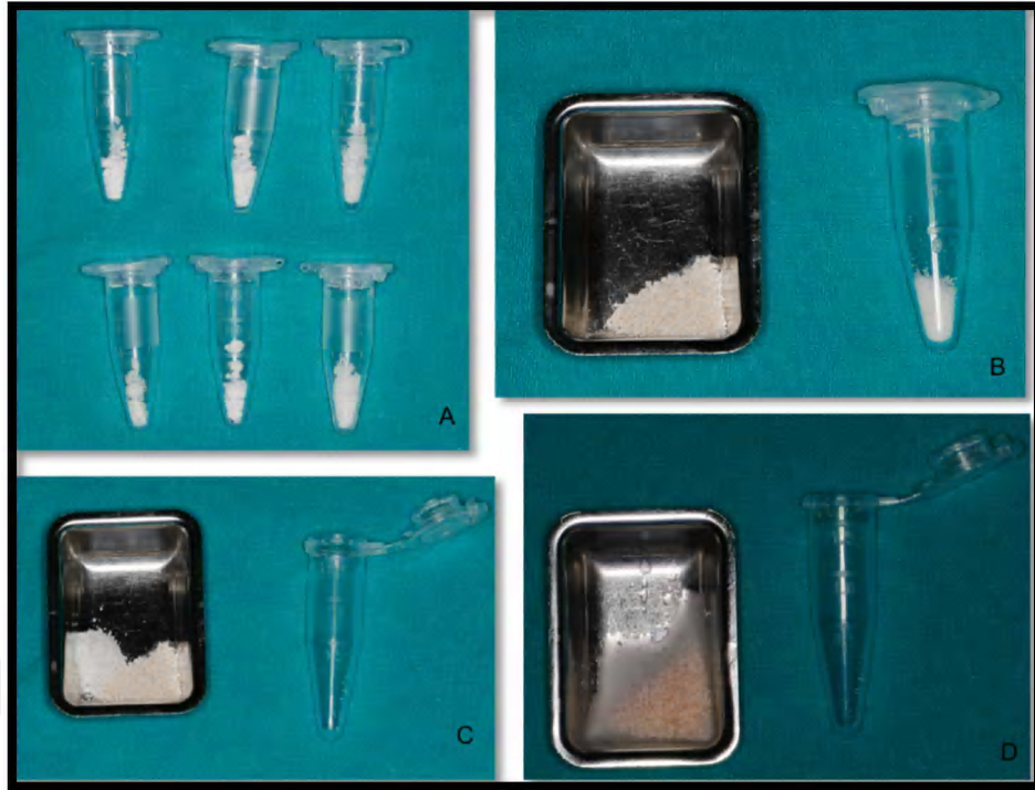
Resim 10. Alendronat yüklü PLGA mikro küreleri(A), DSK grefti ve alendronat yüklü PLGA(B), Graftin alendronat yüklü PLGA ile karışımı(C), Karışımın serum fizyolojik ile sulandırılmış hali(D)
