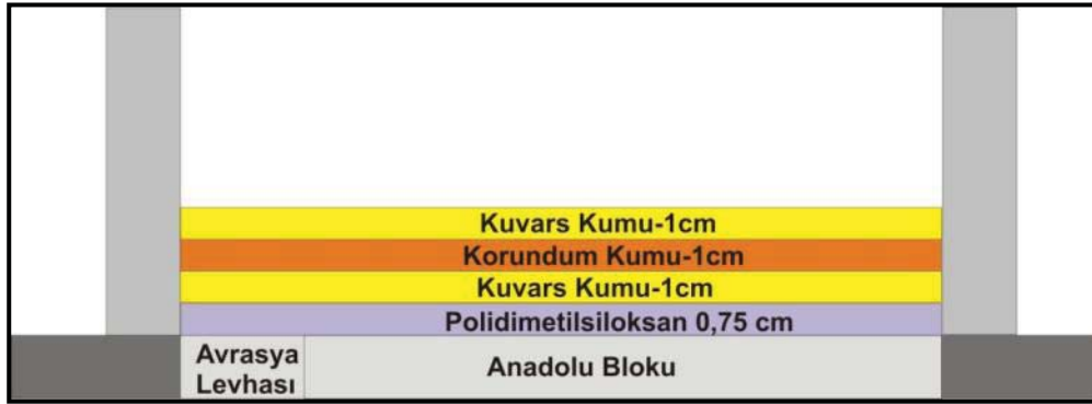
Şekil 4.48 : Deney-3 setinin ön perspektif görünüşünden kullanılan viskoz ve granüler malzemenin kalınlıklarını gösteren plan.
