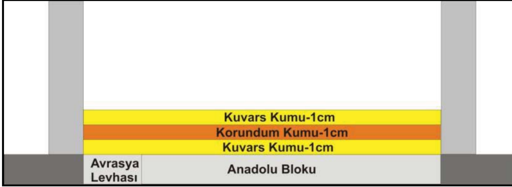
Şekil 4.21 : Deney-1 setinin ön perspektif görünüşünden kullanılan granüler malzemenin kalınlıklarını gösteren plan.
