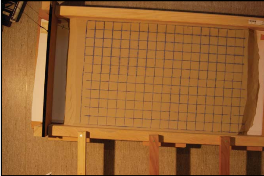
Şekil 4.22 : Deney-1 setinin deformasyon öncesi durumunun gerçek görüntüsü.
