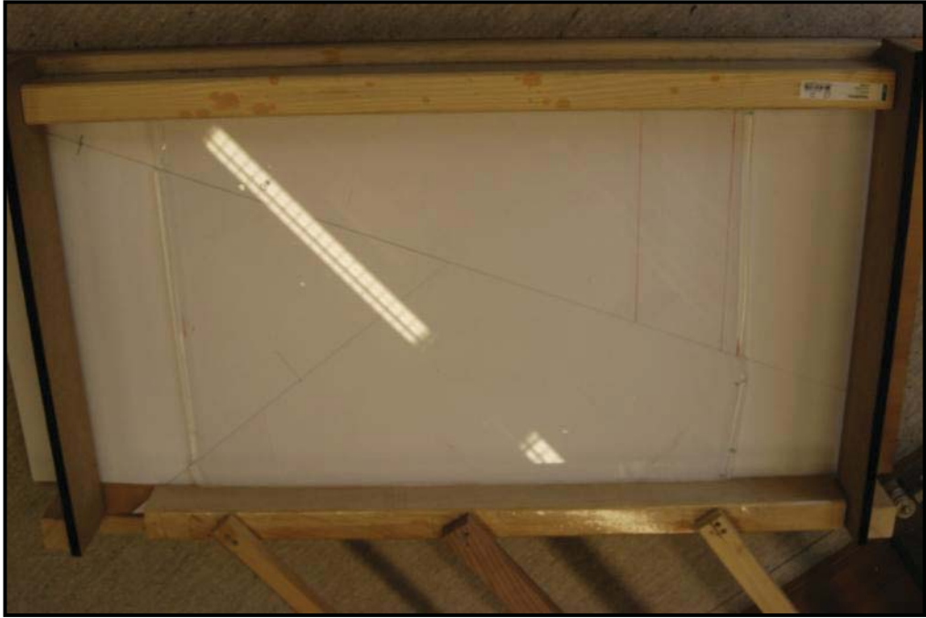
Şekil 4.47 : Deney-3 setinde viskoz malzeme ana tektonik yapıları temsil eden kartonların üzerine serilmiştir.
