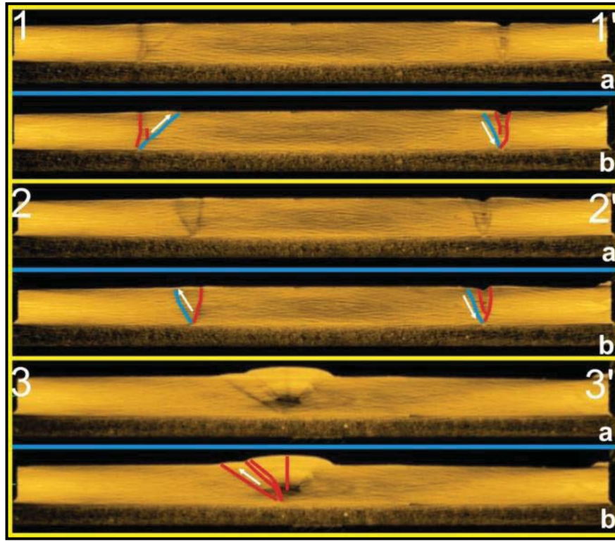
Şekil 4.45 : Deney-2'nin son durumunda yapılan bilgisayarlı tomografi taramalarına ait kesitler (1-1',2-2' ve 3-3' ile gösterilenler Şekil 4.33'de verilmiş kesit yönlerini, a kesitlerin yorumlanmamış, b ise yorumlanmış durumunu gösterir. Mavi çizgiler kısa ömürlü fayları temsil eder).
