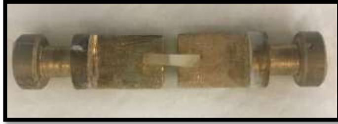
Resim 14. Mikrotensal uçlarına bağlanmış kesit
