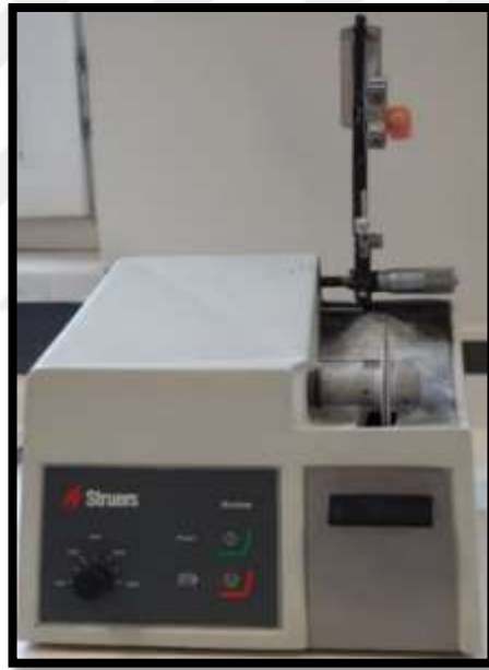
Resim 13. Minitom hassas kesme cihazı(Struers Minitom, Struers GmbH, Kopenhag, Danimarka) ve cihaza yerleştirilmiş örnek.
