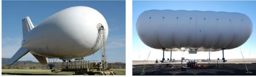
Şekil 3.12 : Büyük gövdeli KGHP için demirleme istasyonu (Tcom & Star Tower).
