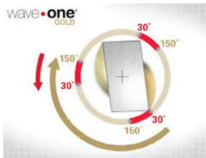
Şekil 2.13. WaveOne Gold resiprokasyon döngüsü
