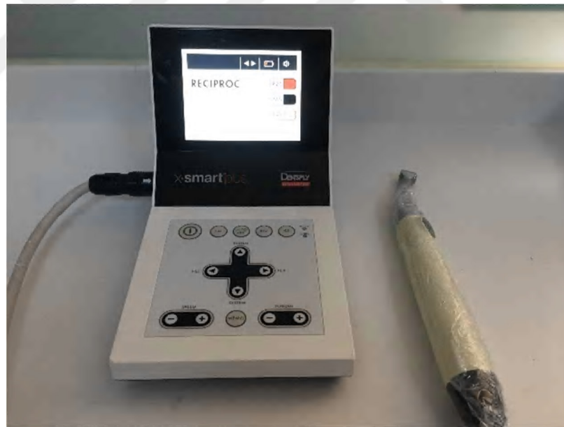
Şekil 3.10. X-Smart Plus endodontik motoru
