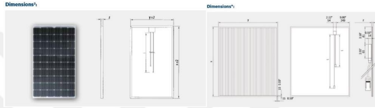
Şekil 6.3 : Bosch marka kristal silikon-thin film panel boyutları (Url-30).
