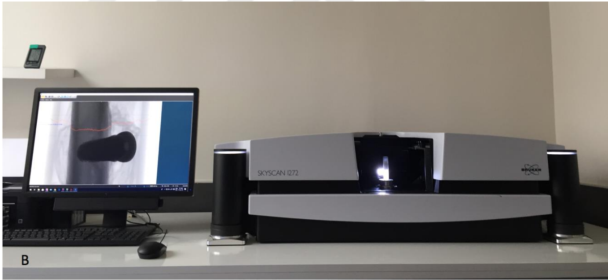
Resim 9. Skyscan 1272 Micro-Bilgisayarlı Tomografi cihazı (Resim 9a), Örneğin tarama için hazırlanması, tarama için cihaza yerleştirilmesi, cihaz ile taranması (Resim 9b)
