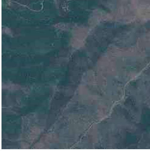
Şekil 6.8 : Butterworth süzgeçli DFT yöntemi ile pan keskinleştirmiş İstanbul orman görüntüsü örneği.
