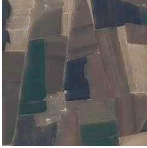
Şekil 6.11 : Butterworth süzgeçli DFT + IHS yöntemi ile pan keskinleştirmiş Urfa tarım arazisi görüntüsü örneği.
