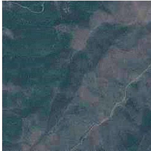
Şekil 6.7 : Gaussian süzgeçli DFT + IHS yöntemi ile pan keskinleştirmiş İstanbul orman görüntüsü örneği.
