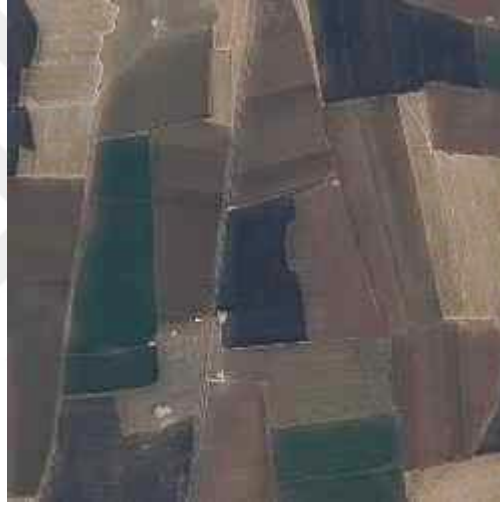
Şekil 6.12 : Gaussian süzgeçli DFT + IHS yöntemi ile pan keskinleştirmiş Urfa tarım arazisi görüntüsü örneği.
