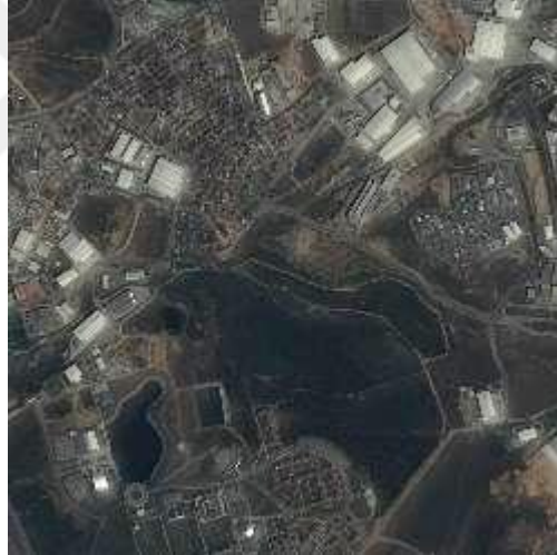
Şekil 6.2 : Butterworth süzgeçli DFT + IHS yöntemi ile pan keskinleştirmiş Gebze şehir görüntüsü örneği.
