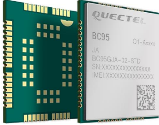
Şekil 3.3 : Quectel BC95 NB-IoT modülü [26].
