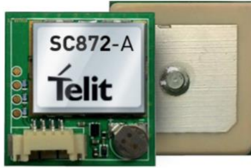
Şekil 3.1 : SC872-A GNSS modülü [24].
